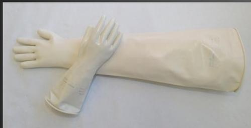
Специальные перчатки изготовлены из хлорсульфированного полиэтилена (ХСП). Перчатки подходят для работы с окислителями, концентрированной азотной кислотой, концентрированной соляной кислотой, аммиаком, концентрированными щелочами и спиртами.
